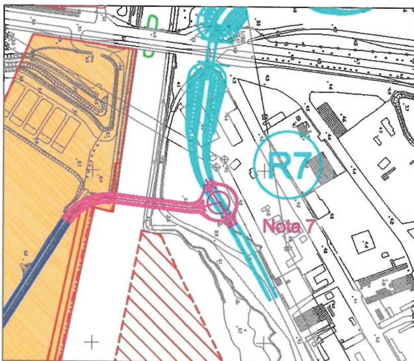
Fig.5 – La nuova rotatoria R7ed il nuovo ponte sul Fosso Cornia Vecchia (Nota 5)
