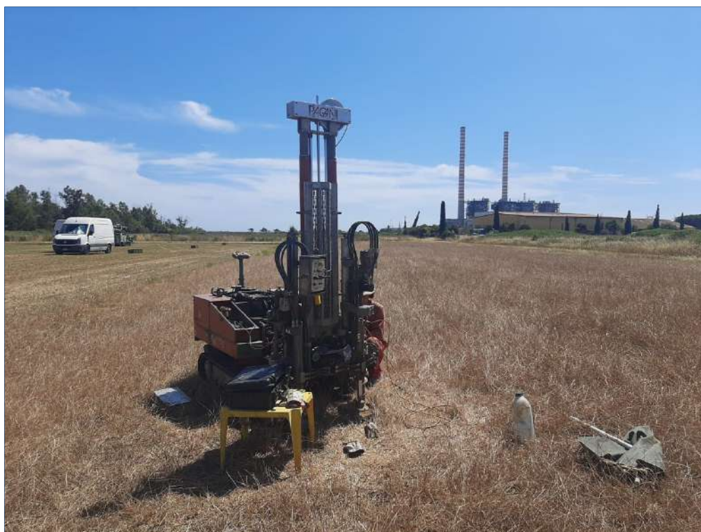
Figura 1: Postazione prova penetrometrica P13
