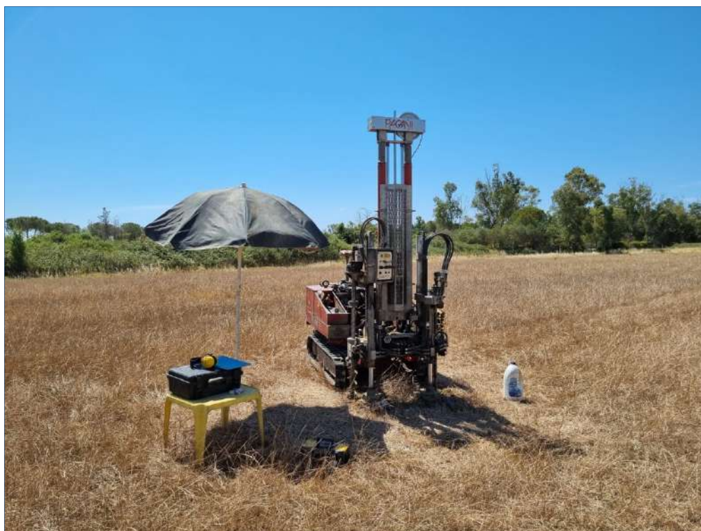
Figura 2: Postazione prova penetrometrica P14
