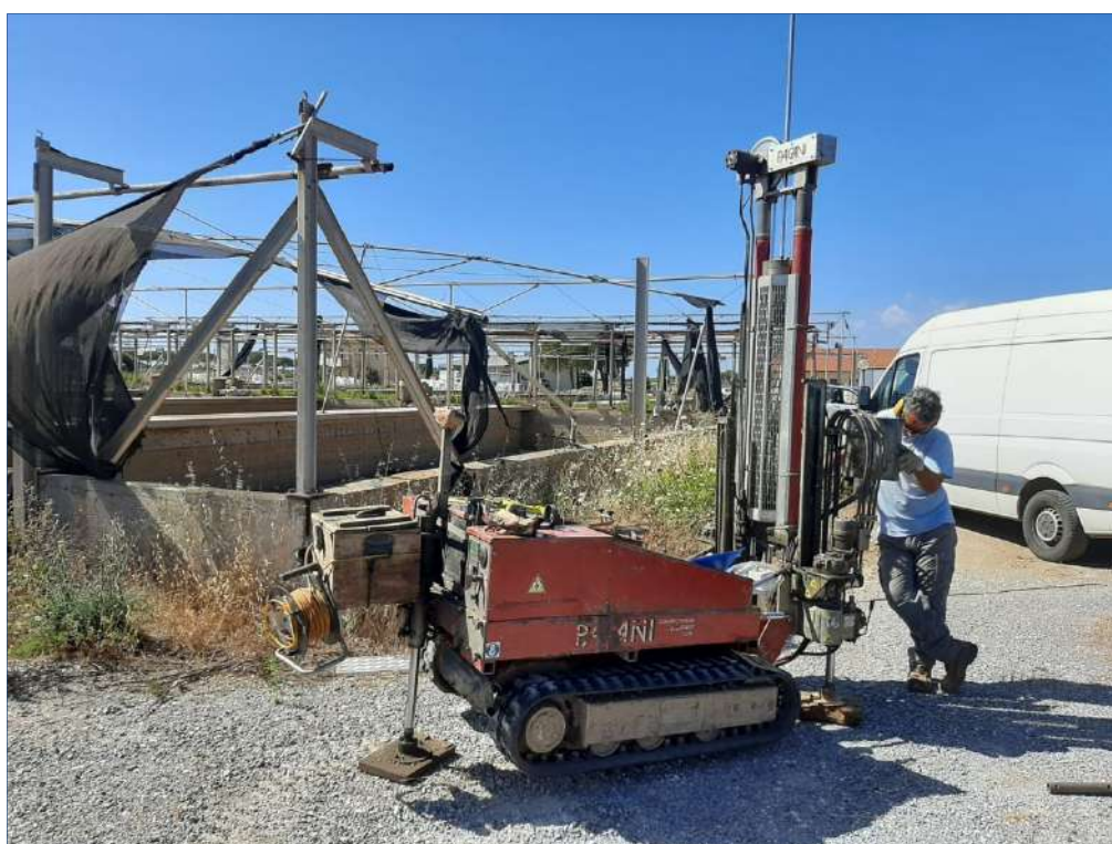
Figura 2: Postazione prova penetrometrica DIN 6
