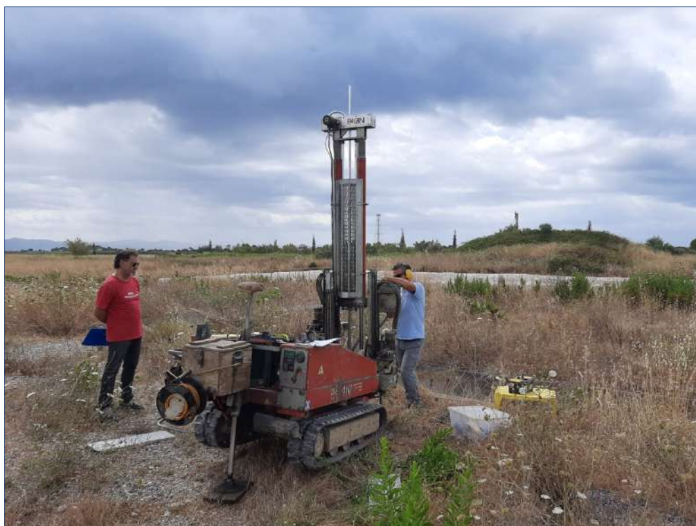
Figura 1: Postazione prova penetrometrica DIN 2
