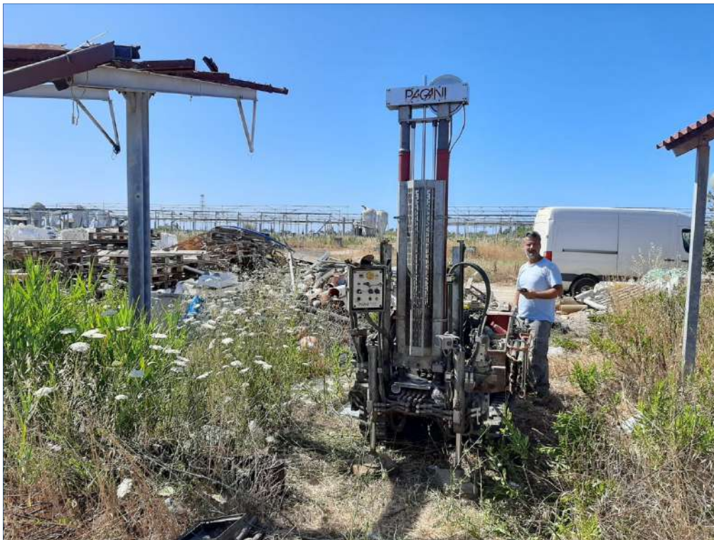
Figura 3: Postazione prova penetrometrica DIN 8
